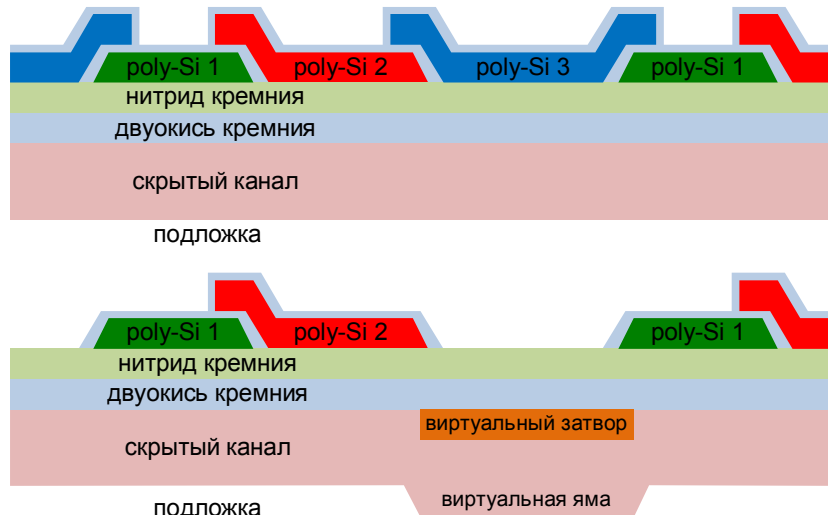
Рис. 5. Сечение трёхфазного ПЗС с электродами из поликристаллического кремния (вверху) и с виртуальной фазой (внизу). Около половины площади ячейки свободно от поликремния.
